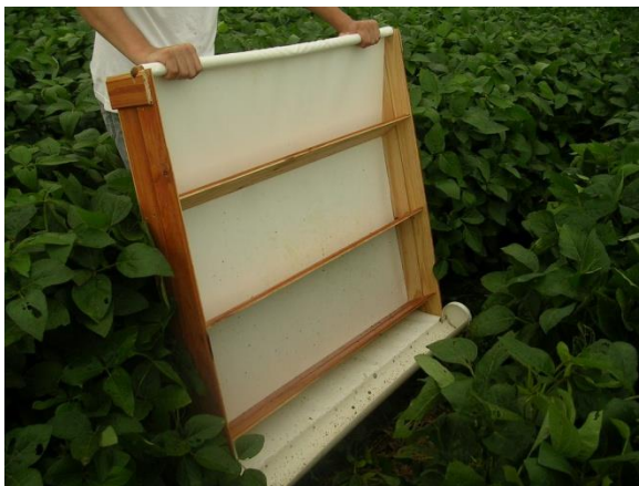
Foto 3: Detalle del dispositivo para el muestreo por estratos de plagas (patente en trámite).
