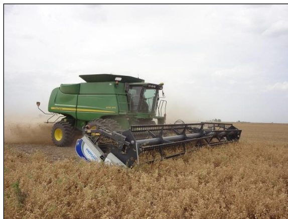
Figura 3. Cabezal Draper cosechando Garbanzo ( Cicer arietinum ), en forma directa.
