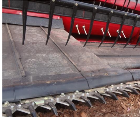
Figura. Sistema de corte alternativo de 3" x 3" de un cabezal Draper
