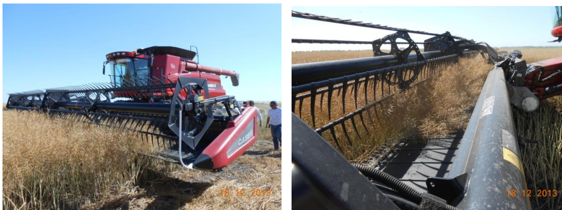
Figura 2. Izquierda: cabezal Draper cosechando Colza ( Brassica Napus ), en forma directa en la provincia de Buenos Aires. Derecha: La colza cortada avanza sin pre trilla por el cabezal Draper.
