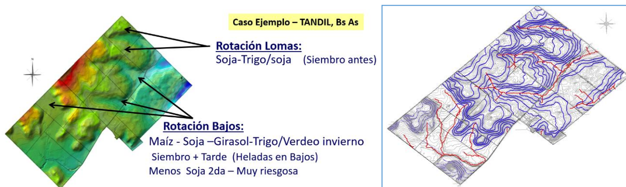
Figura 2. Mapas de altimetría digital – Delimitación de ambientes de loma y bajo (izquierda) y terrazas con sus vías de desagüe (derecha), en un establecimiento del partido de Tandil
